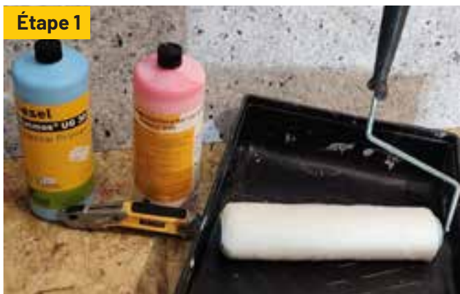
Outils et produits requis pour l'installation du OkaQuiet : Okatmos UG 30 ou Okatmos DSG, rouleau à peinture et couteau à placoplâtre.
